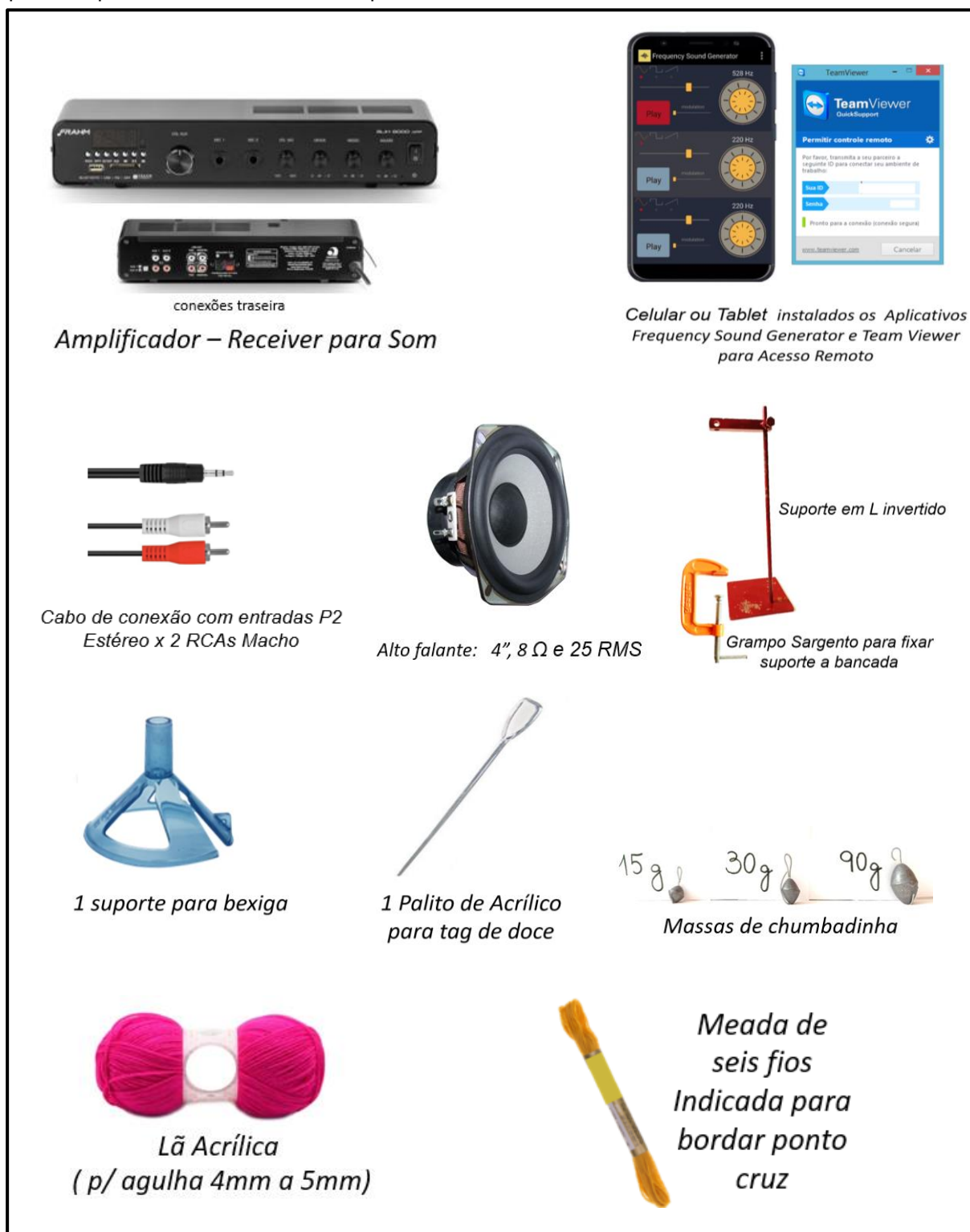
Figura ApB.1 - Recursos para o experimento da corda vibrante por acesso remoto. ApB 1 - Recursos para o experimento da corda vibrante por acesso remoto.
