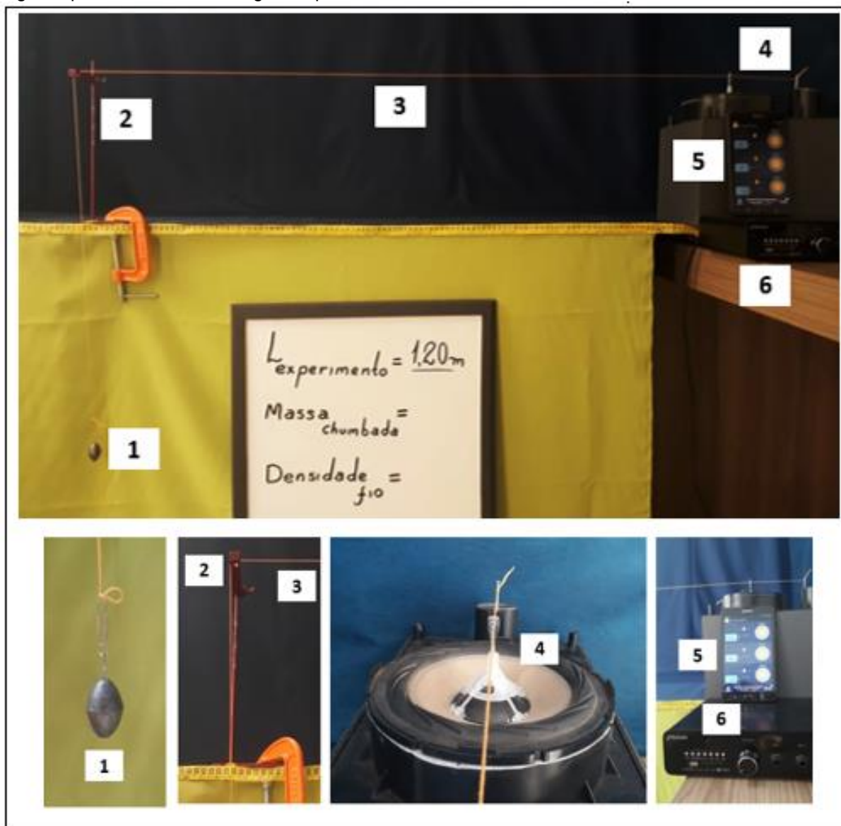
Figura ApB.2 - Foto da montagem experimental da corda vibrante.
