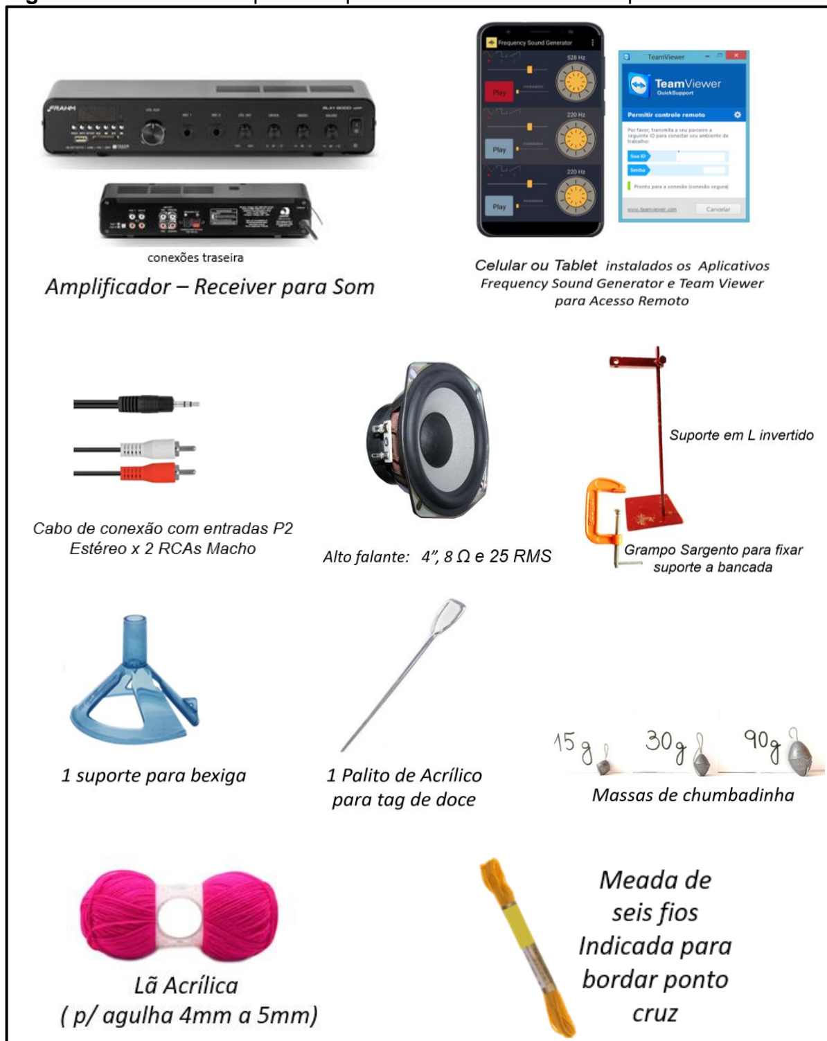
Figura APF.1: Recursos para o experimento da corda vibrante por acesso remoto
